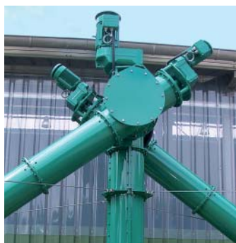
Percorso di trasporto verticale a spirale con 2 percorsi alternativi per l'immissione del fermentatore
