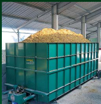
Sistema di dosaggio per sostanze solide Serie SBC, 60 m 3
