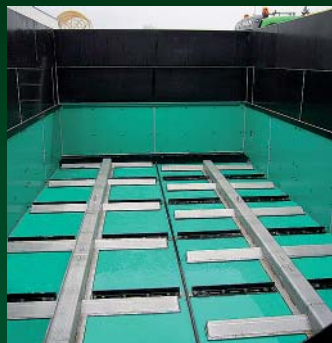
Rivestimento in plastica Fondo di spinta in acciaio Serie SBC
