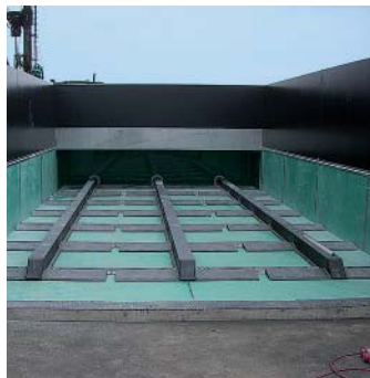
Rivestimento in plastica Telai di spinta in acciaio Serie ZBC
